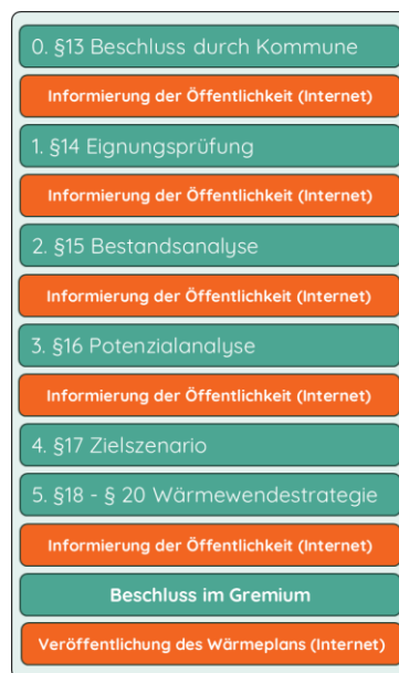
Abbildung 2: Ablauf der Wärmeplanung nach § 13 WPG
